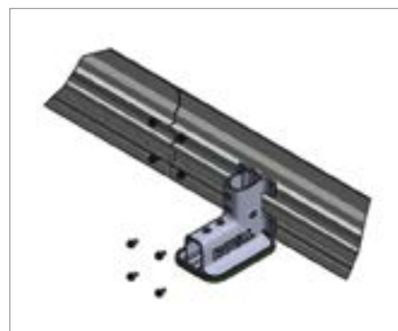
Plintbevestiging aan koppelvoet
