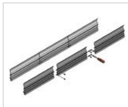
Plintdelen worden aan elkaar bevestigd
